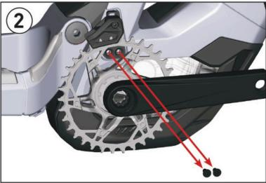
FR / Retirer les deux vis à tête fraisée du support de guide-chaîne.
